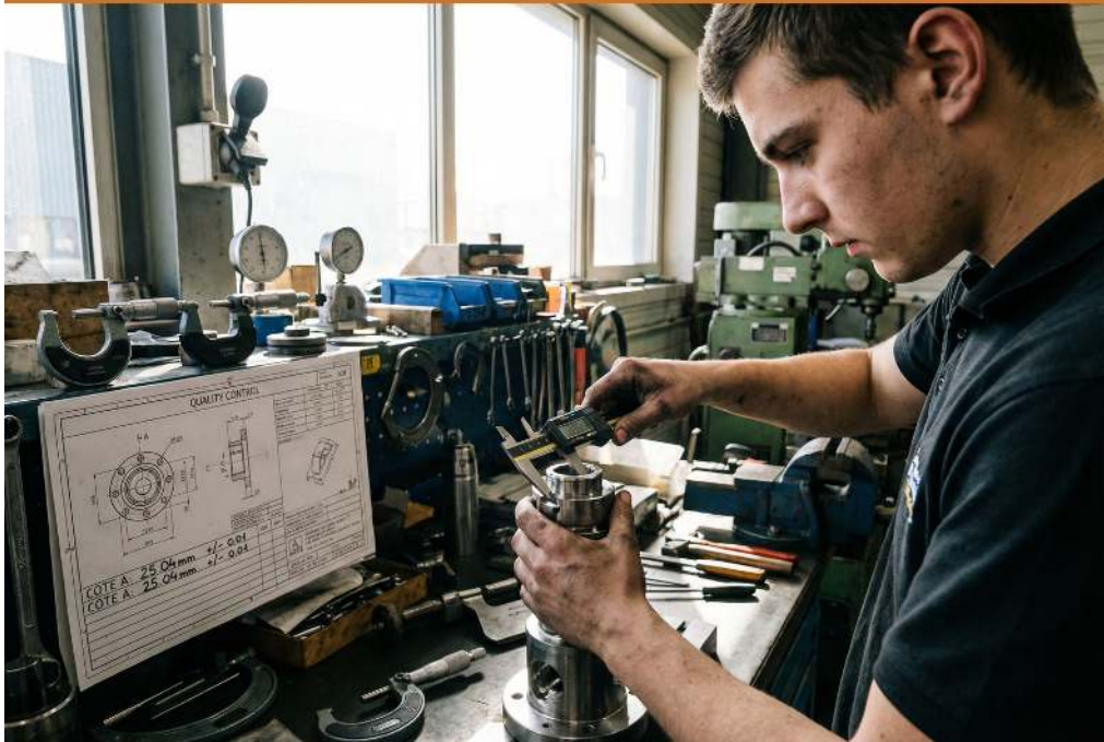
Vérification de la longueur et de la perpendicularité pour une tolérance de \pm 0,1 mm
